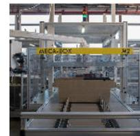
**Formeuse de carton** – (ouverture et formation automatique des cartons)
